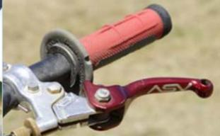
Wenn schon, denn schon: Klappbare Hebel schätzt man, wenn ein nicht-klappbarer beim Sturz gebrochen ist
