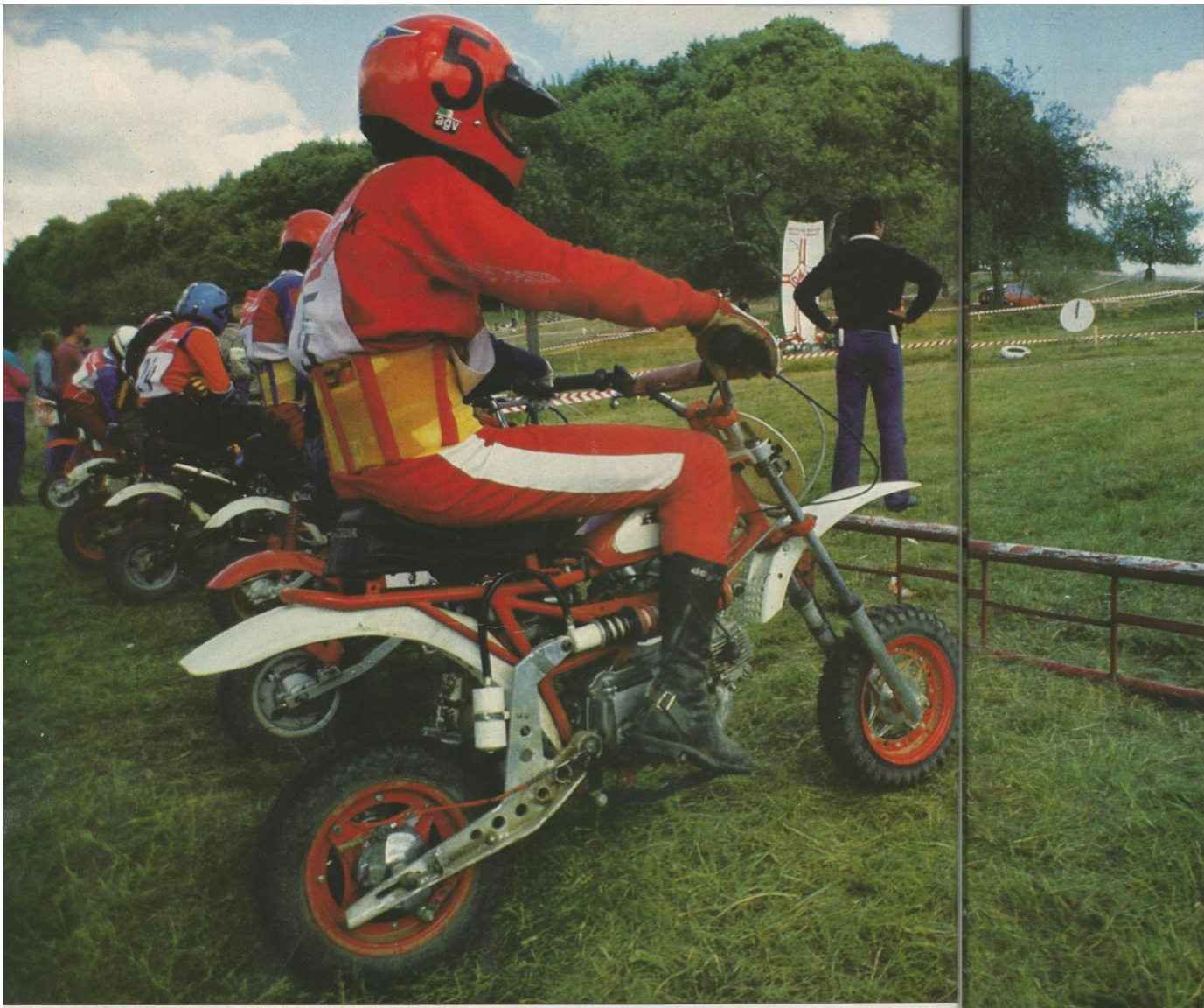
Die Basis: Im Serienzustand leistet die kleine Honda 1,8 PS bei 6000/min, die Crosser dagegen holen ganze 12 PS aus 75 cm³
