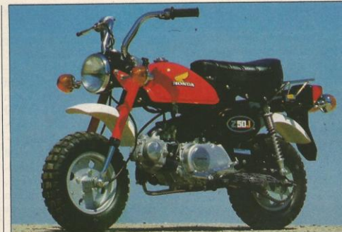
Die Basis: Im Serienzustand leistet die kleine Honda 1,8 PS bei 6000/min, die Crosser dagegen holen ganze 12 PS aus 75 cm³
